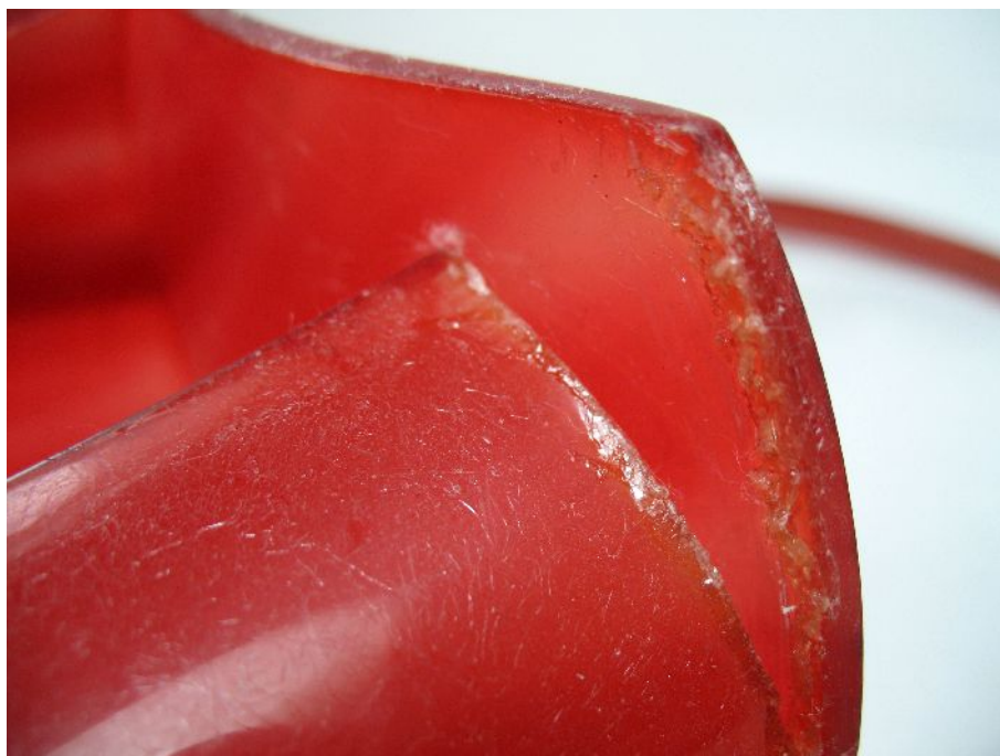
Abbildung 4: An dieser Stelle sind die Seitenwände voneinander gelöst, die vordere Wand ist stark nach innen verbogen
