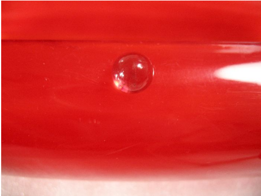
Abbildung 13: Die nadelartigen Kristalle konnten von der Oberfläche entfernt werden. Wie lange der Reinigungseffekt anhalten wird, ist nicht vorhersehbar.
