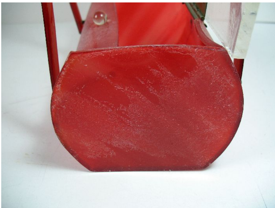
Abbildung 6: Das Muster der Kristallbildung weist einen Zusammenhang mit dem Streifenmuster des Materials auf
