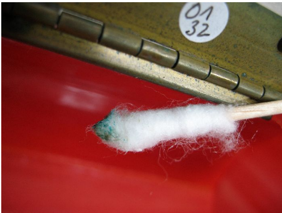
Abbildung 10: Abpudernde Bestandteile der grünlichen Korrosionsschicht konnten ebenfalls mit einem trockenen Wattestäbchen abgerieben werden
